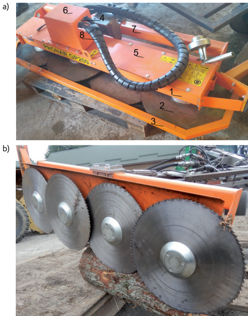
Ryc. 1. Piła do gałęzi Pronar GP200: a) rysunek poglądowy: 1 – rama, 2 – piła tarczowa, 3 – osłona transportowa, 4 – silnik hydrauliczny, 5 – pokrywa, 6 – osłona silnika hydraulicznego, 7 – belka nośna, 8 – szybkozłącza przewodów hydraulicznych, 9 – zestaw kluczy specjalistycznych; b) widok elementów roboczych (fot. K. Słowiński)
