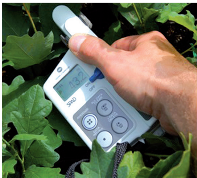
Ryc. 9. a) Pomiar wskaźnika powierzchni liści LAI na polu produkcyjnym sadzonek buka; b) Pomiar zawartości chlorofilu w liściach sadzonek dębu szypułkowego (fot. G. Durło)
