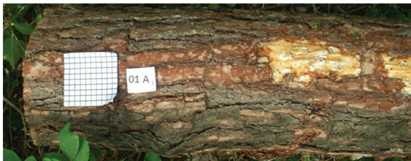
Ryc. 1. Kłoda sosnowa z widocznymi uszkodzeniami od zespołu podającego głowicy (fot. K. Ryglewicz)
