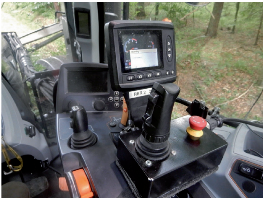
Ryc. 2. Miejsce pracy, sterowania narzędziem tnącym oraz wysięgnikiem (fot. K. Słowiński)
