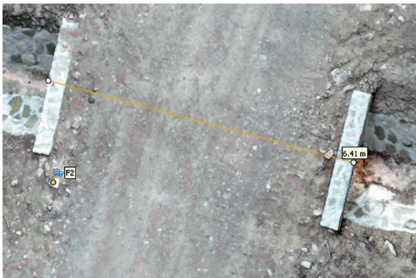
Ryc. 17. Długość przepustu rurowego (źródło: program Agisoft PhotoScan)
