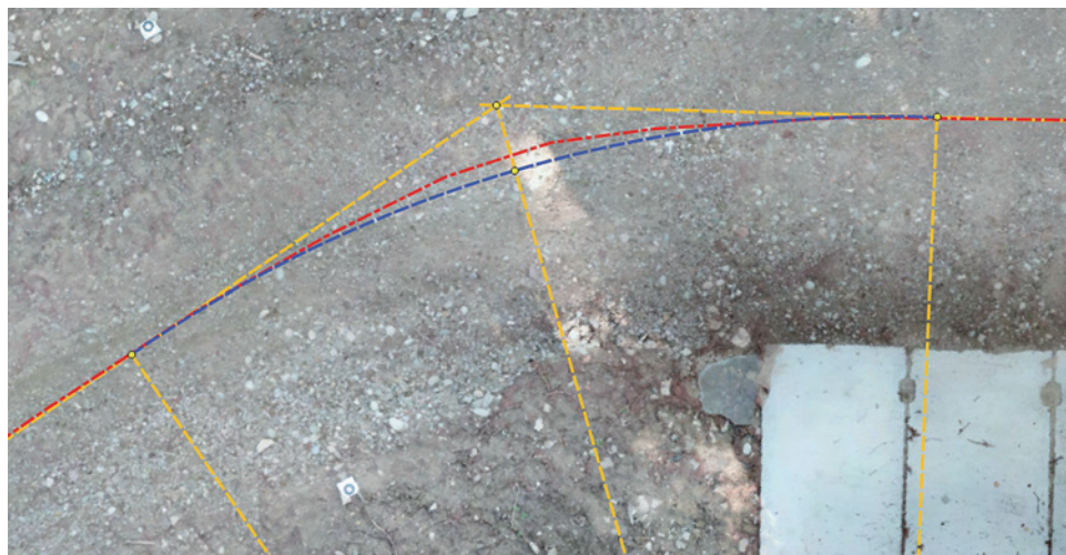
Ryc. 23. Wzajemne ułożenie zrealizowanej trasy i krzywizny łuku kołowego o promieniu 14 m (źródło: program QGIS)
