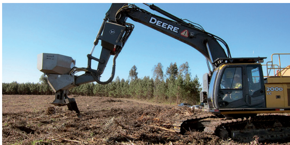
Ryc. 2. Agregat sadzeniowy Bracke Planter zamontowany na wysięgniku koparki gąsienicowej (fot. J. Walczyk)
