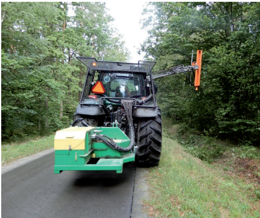
Ryc. 3. Agregat z piłą do gałęzi Pronar GP200 w czasie pracy: a) widok z przodu, b) widok z tyłu (fot. K. Słowiński)
