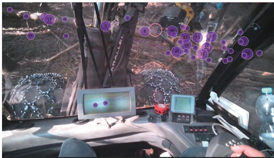
Ryc. 8. Gaze plot – okrzywanie harvesterem 1 sekcji na stoku o nachyleniu 48% (fot. G. Szewczyk)
