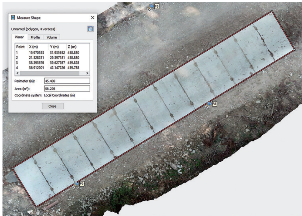
Ryc. 16. Wielkość powierzchni składnicy drewna (źródło: program Agisoft PhotoScan)
