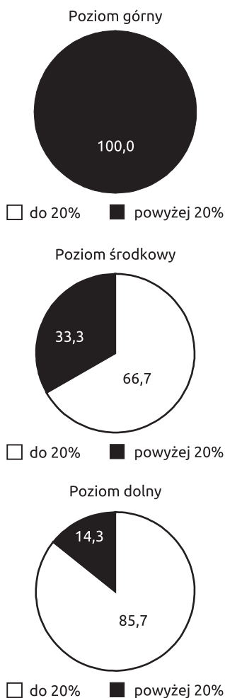
Ryc. 8. Udział wałków z poszczególnych poziomów stosu w przedziałach wilgotności drewna do 20% i powyżej 20% (oznaczonych metodą suszarkowo-wagową)
