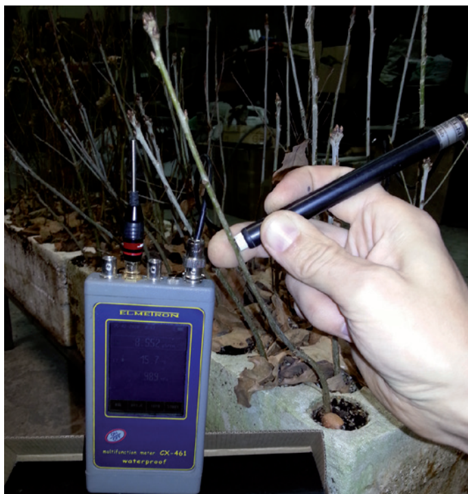
Ryc. 3. Wykonanie pomiaru admittancji w potowie zdrewniałego pędu (strzałki) sadzonki (fot. Ł. Mateusiak)
