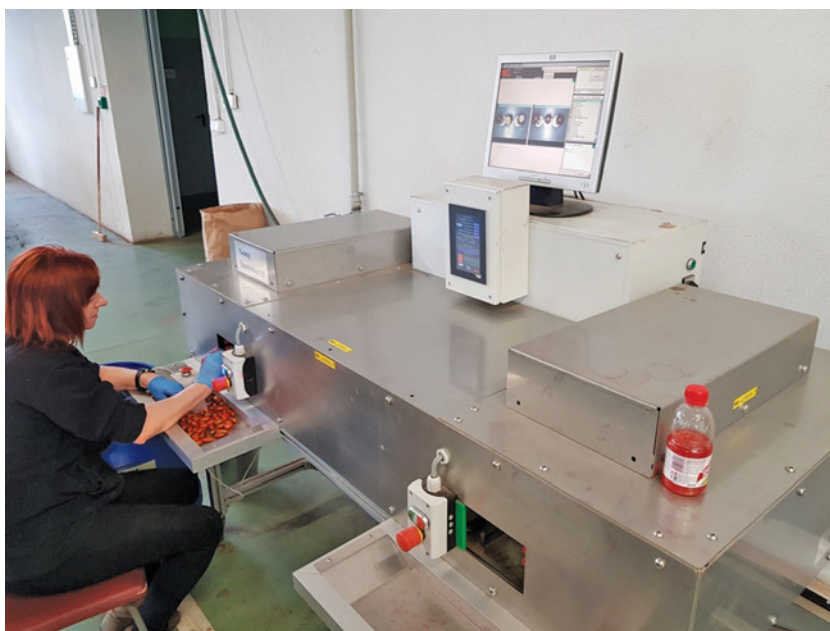
Ryc. 3. Skaryfikator półautomatyczny, model Quercomat Q1 (fot. P. Tylek)
