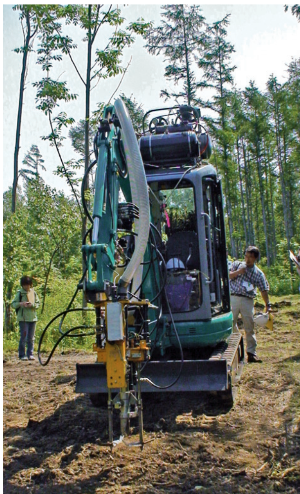
Ryc. 3. Prototyp głowicy sadzącej zamontowanej na mikrociągniku gąsienicowym (fot. J. Sowa)
