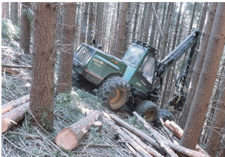
Ryc. 2. Harwester Timberjack podczas pracy w terenie o spadku 48% (fot. G. Szewczyk)
