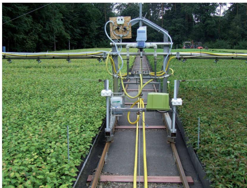
Ryc. 2. Rampa deszczująca z zamontowanym systemem kontroli nawadniania i nawożenia (fot. M. Kormanek)
