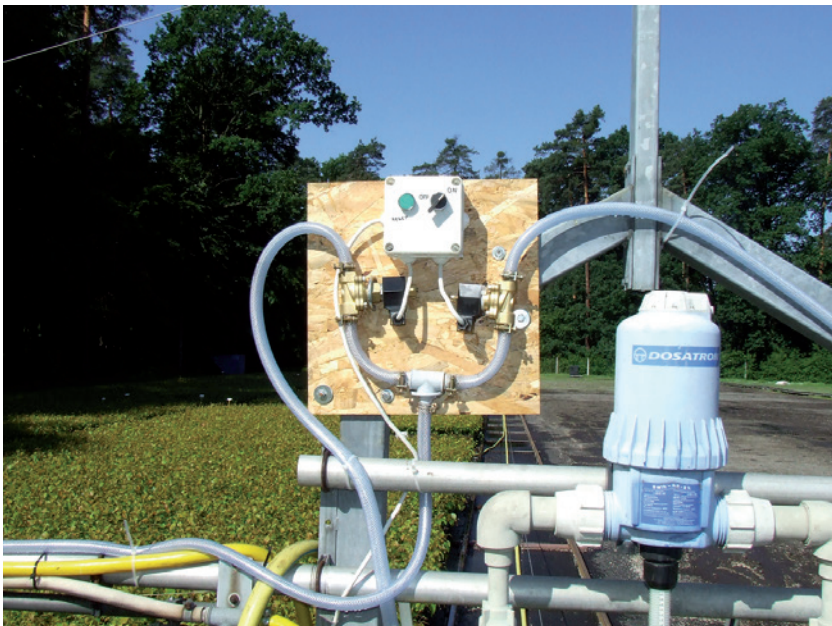
Ryc. 1. a) Domontowana dodatkowa rura wraz z głowicami zraszającymi; b) Układ sterowania oraz zawory sterujące dopływem wody i nawozu (fot. M. Kormanek)
