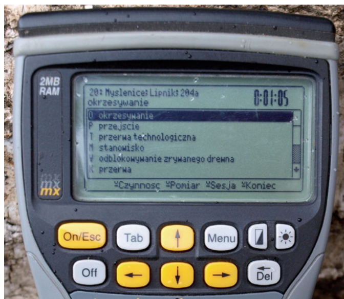
Ryc. 3. Ekran rejestratora PSION z uruchomionym programem TIMING 1.1 przy pomiarze czasu okrzyszwania (fot. A. Stańczykiewicz)
