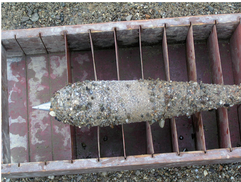
Ryc. 3. Pobór prób materiału mineralnego in situ metodą zamrażania (fot. E. Słowik-Opoka)
