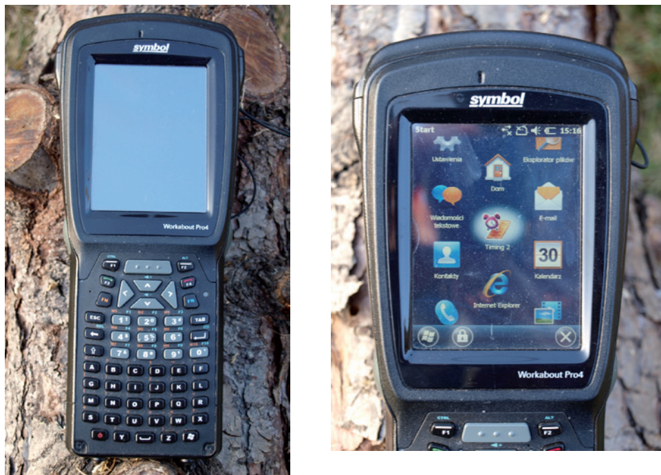
Ryc. 4. Terenowy rejestrator PSION Workabout Pro4 z programem TIMING 2 (z prawej) do badań chronometrażowych i migawkowych (fot. A. Stańczykiewicz)
