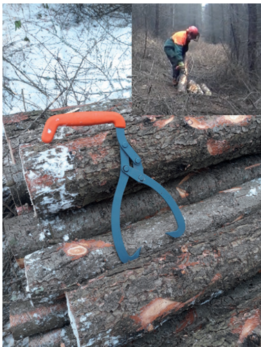
Ryc. 1. Ręczny transport drewna za pomocą kleszczy firmy EIA, masa 930 g (fot. T. Rebizak)
