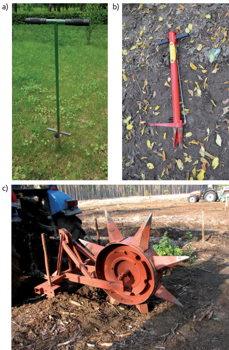
Ryc. 1. Kostury do sadzonek z bryłką: a) strzemiączkowy; b) rurowy; c) karuzelowy (fot. P. Tylek, J. Walczyk)
