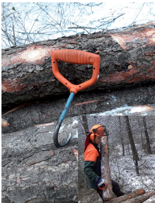
Ryc. 2. Ręczny transport drewna za pomocą haka firmy EIA, masa 495 g (fot. T. Rebizak)
