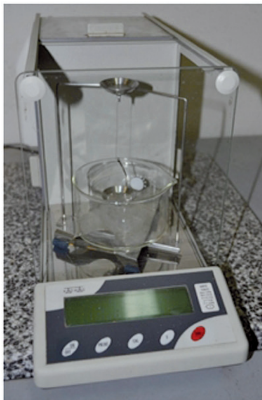
Ryc. 2. Waga pomiarowa z zestawem do pomiaru gęstości ciał stałych (fot. D. Owoc)
