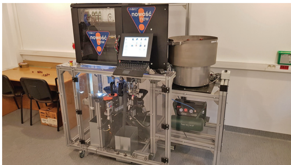
Ryc. 4. Widok funkcjonalnego modelu automatu do skaryfikacji żołądździ (fot. P. Tylek)
