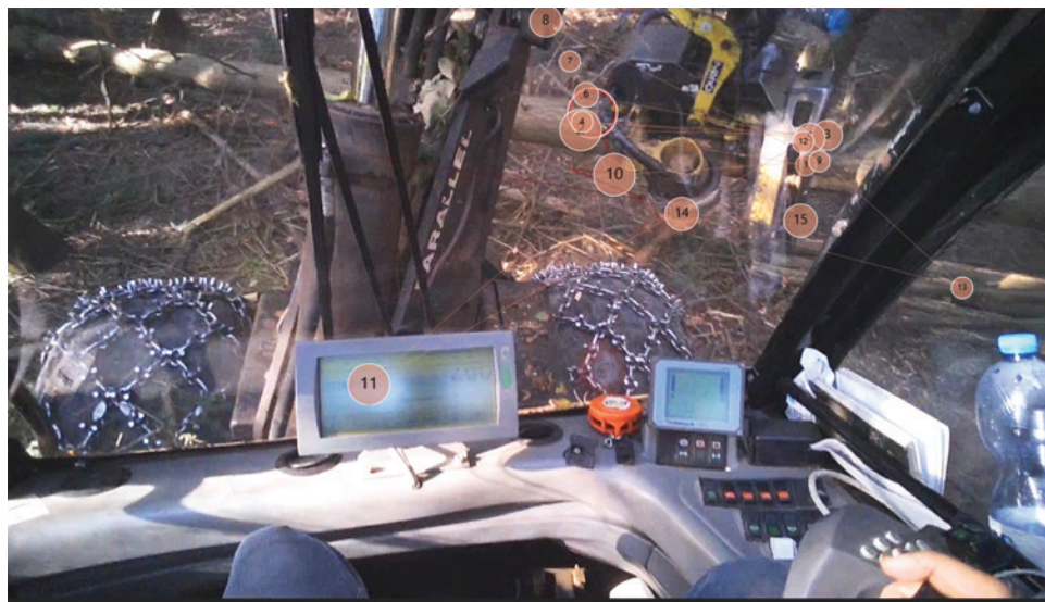
Ryc. 7. Gaze plot – okrzywanie harvesterem 1 sekcji na stoku o nachyleniu 9% (fot. G. Szewczyk)
